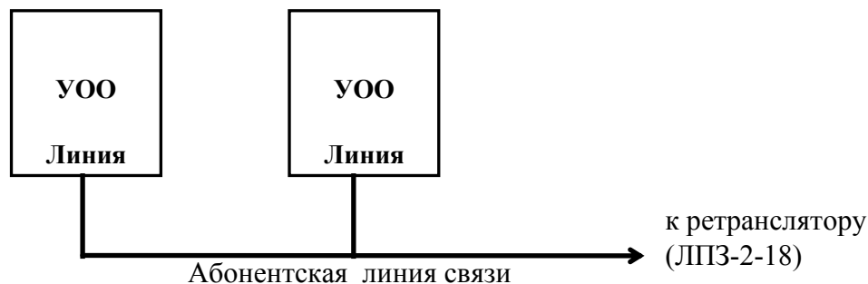
Рисунок 6.1 Подключение двух УОО к одной линии связи
