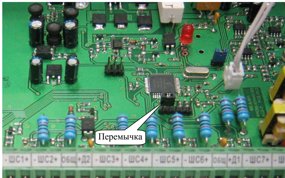
Рисунок 5.4. Установка перемычки для перевода УОО в автономный режим работы
