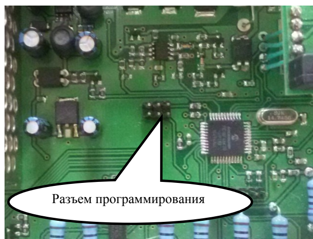
Рисунок 10.1. Подключение программатора к приборам А-801, А-401.
