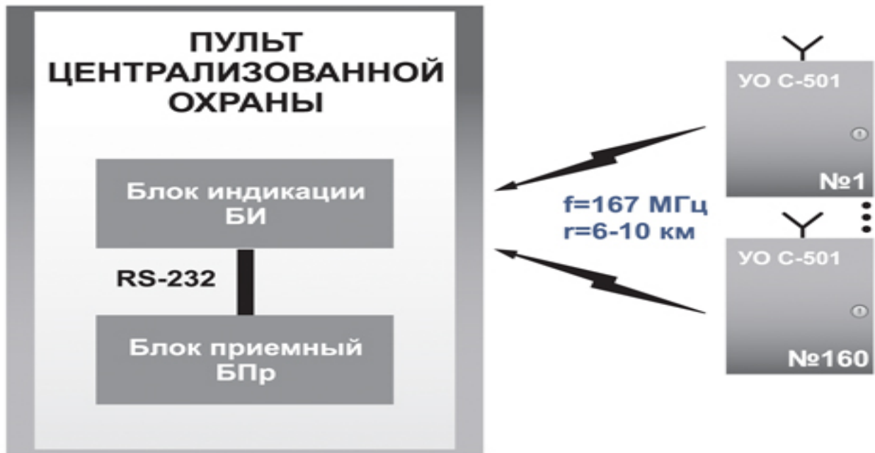
Рисунок 1. Структура системы без ретрансляции (исп. 1)
